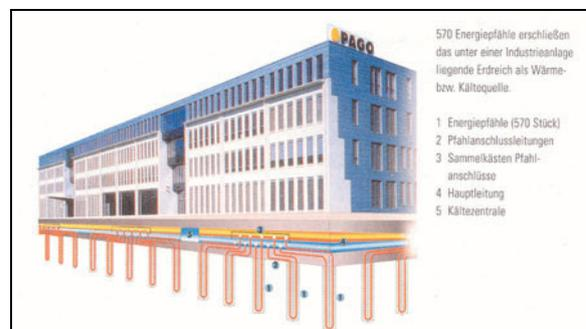
Abbildung 6: Schema erdberührte Betonbauteile.
