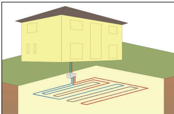
Abbildung 5: Schema Erdwärmekollektor.
