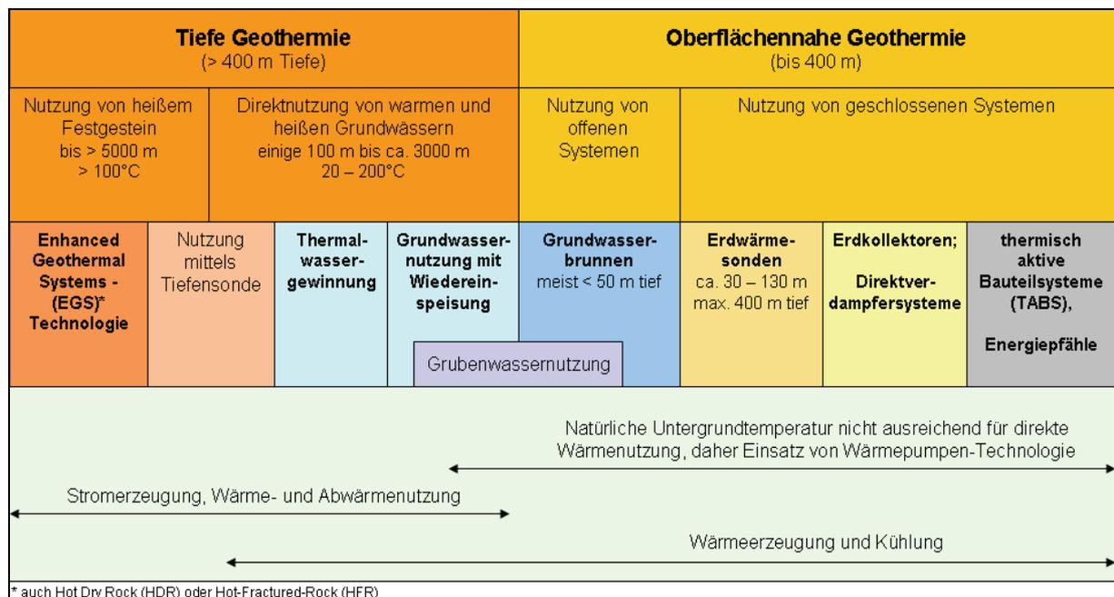
Abbildung 2: Übersicht Beispiele der Erdwärmenutzung.
