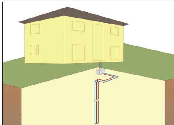
Abbildung 3: Schema Erdwärmesonde.
