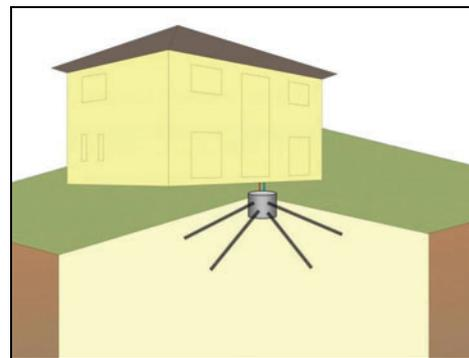
Abbildung 4: Schema schräge Erdwärmesonden nach GRD<sup>®</sup>-Verfahren.
