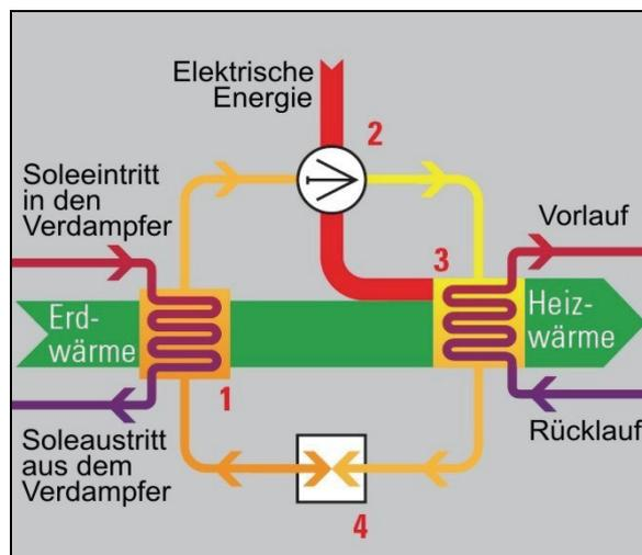
Abbildung 10: Funktionsprinzip einer Sole/Wasser-Wärmepumpe.
